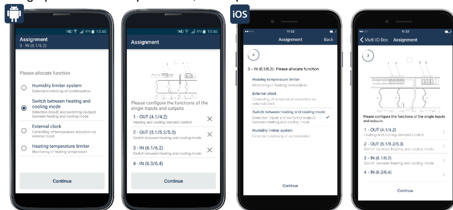
Screenshot Konfiguration Multi IO Box für Wechsel zwischen Heiz- und Kühlbetrieb über einen extern angeschlossenen Schalter (2)
