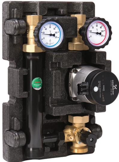
Модули МК применяются в любом смесительном контуре, т.е. в контуре, в котором необходимо держать определённый температурный график за счёт подмеса охлаждённого теплоносителя обратной линии в подающую. Чаще всего используются в качестве контура "тёплого пола", контура радиаторного отопления с точным управлением температурой, и т.п. Для автоматического осуществления подмеса необходим электросервопривод (см. "Сервоприводы").
