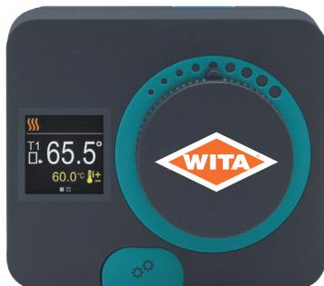
Предназначен для автономного управления смесительным клапаном с целью поддержания постоянной заданной температуры теплоносителя. Наиболее часто используется для контроля температуры обратной линии к котлам с чугунным теплообменником, или для контроля постоянной температуры подающей линии в системах отопления "тёплый пол".
