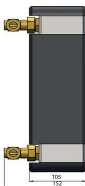
Габаритные и монтажные размеры теплообменника IC8Tx24 (30кВт)
