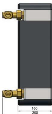
Габаритные и монтажные размеры теплообменника IC8Tx30 (40кВт)
