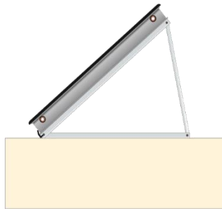
На бетонном основании
